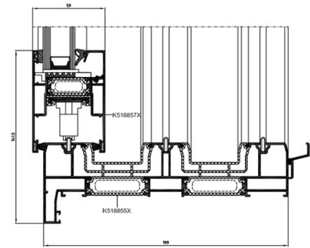
Unterer Schnitt Tür mit 3 Laufschienen
