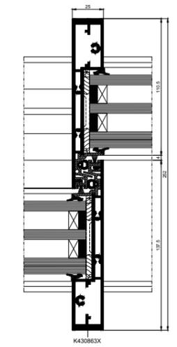
Schnitt durch die Flügel-Tür Verbindung
