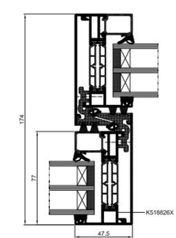
Schnitt durch die Verbindung der Flügel
