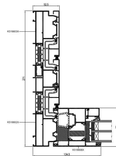
Schnitt durch die Tür mit 3-Schienen-Rahmen
