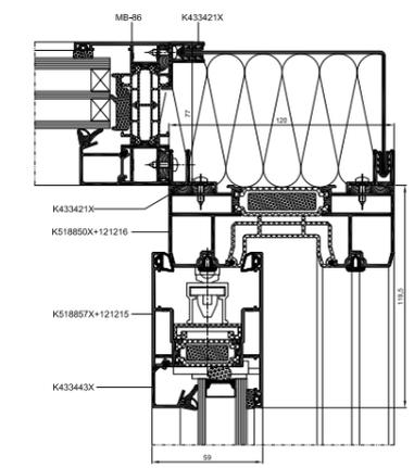
Schnitt durch den 90° Eckverbindung der Tür MB-59HS mit festem Fenster
